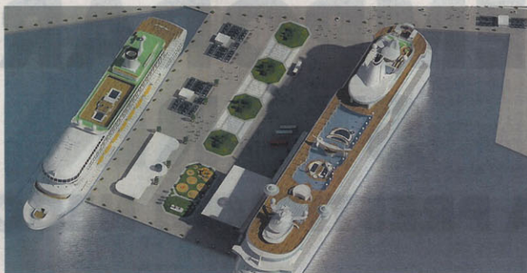
Le nuove banchine 2 e 4 per l'attracco delle grandi navi da crociera a partire dal 2017, disegnate dall'Authority. Al centro il terminal turisti e zone di accoglienza
